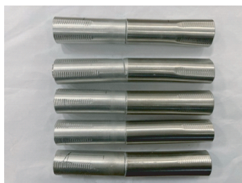
图 10 拉伸试样断裂位置
